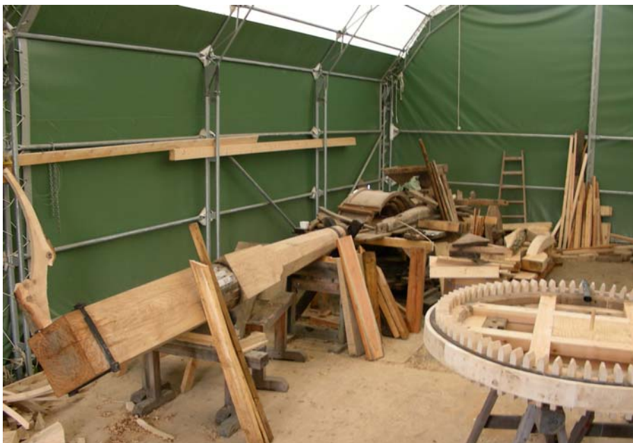
Til venstre den færdige mølleaksel. Til højre hathjulet med side ”tænder” af hvidbøg og bremsebelægning af poppel. I baggrunden ”lageret” af de originale dele, som enten skal genmonteres eller kopieres.
