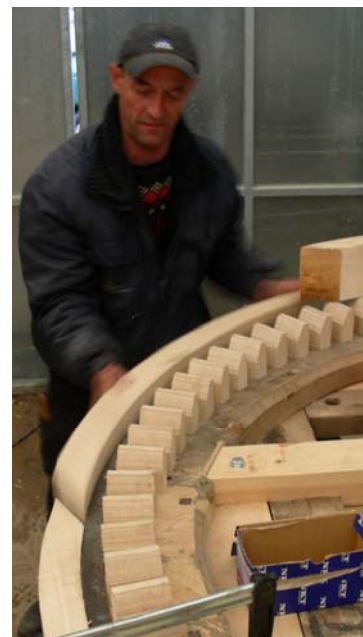
De krummes poppelstykker skal passes nøje sammen og dyvles på hathjulets yderside.
